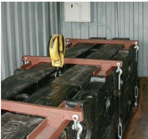
Рис.3. Укладка гирь ГО-П-1000 на стеллаже СПВЛ
