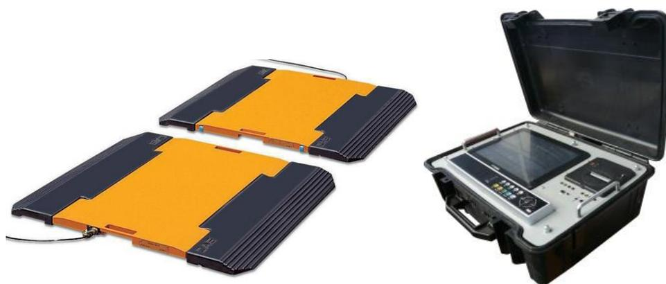
Принцип действия систем основан на преобразовании деформации упругого элемента весоизмерительного тензорезисторного датчика (датчиков), возникающей под действием силы тяжести взвешиваемого груза, в аналоговый электрический сигнал, изменяющийся в зависимости от измеряемой нагрузки. Сигналы от датчиков преобразуются в цифровые при помощи блока управления. Информация об осевых нагрузках, общей массе ТС и сообщения об ошибках в работе систем выводится на монитор и принтер блока управления «Трак 2».
